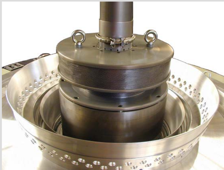
[Innenkühlungssysteme zur Vermeidung von Kondensatbildung]
